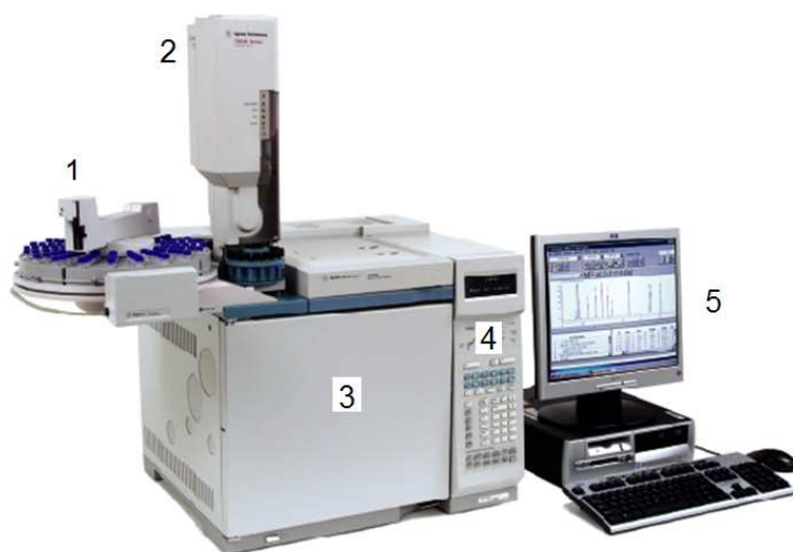
Слика 11. Спољашњи изглед гасног хроматографа:
